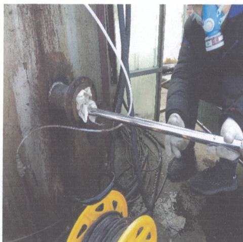
图1 有组织废气采样
