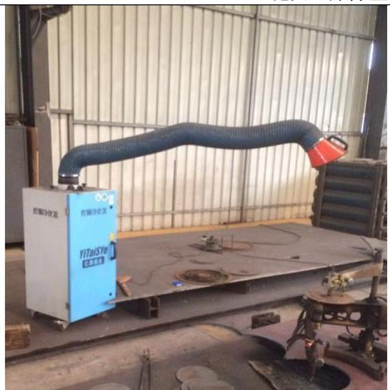
焊接工序移动式焊烟净化装置
